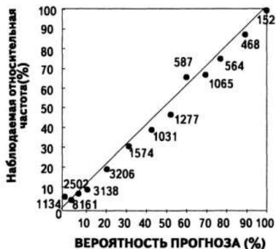
Рис. 9. Данные калибровки для прогнозов осадков. Числа возле точки – количество прогнозов. Видно, что вероятность прогноза хорошо коррелирует с относительной частотой осадков, что говорит о хорошей калибровке синоптиков
