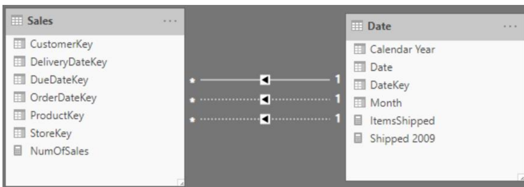
Рис. 3.8. Две таблицы не могут быть объединены более чем одной активной связью
