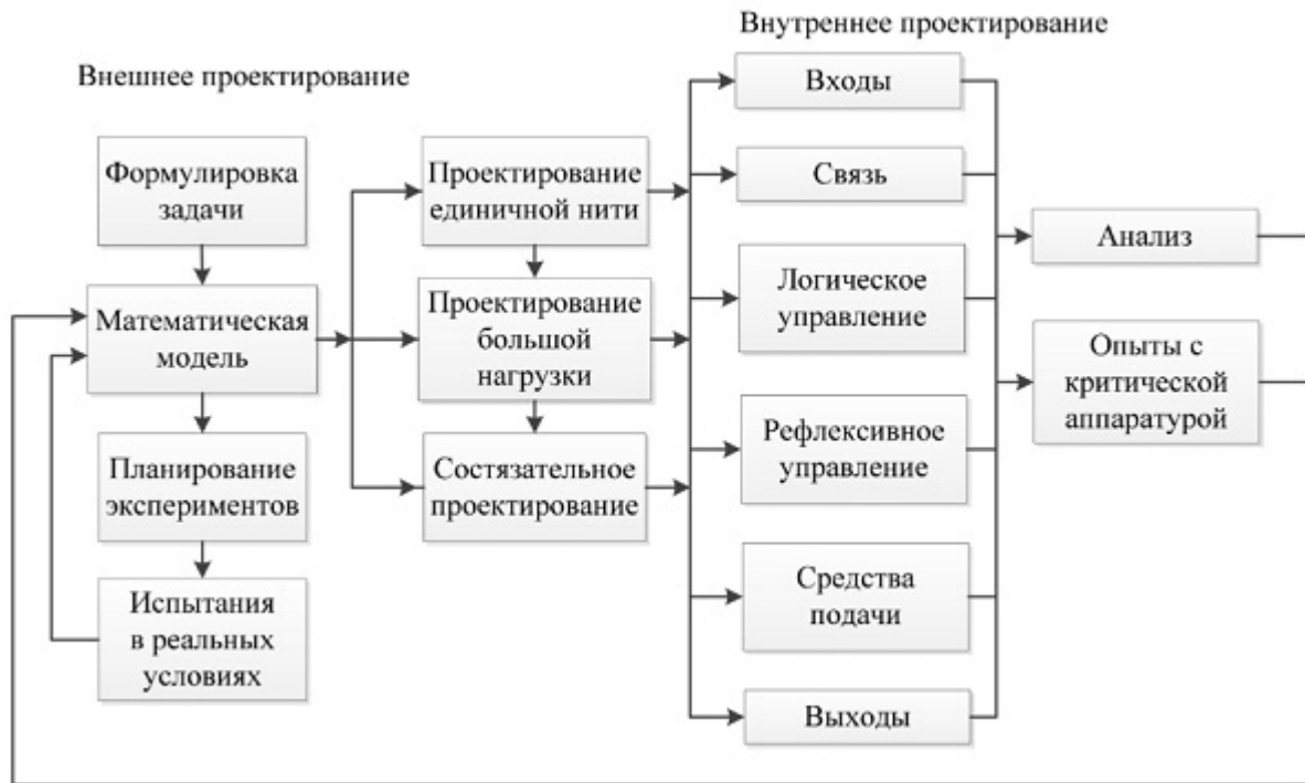
Рис. 3. Этапы проектирования системы – фаза предварительного проектирования
